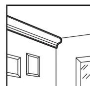
■ Fijación de molduras de poliestireno expandido
