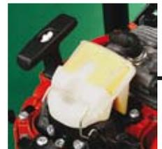
Dos tipos de filtro en equipo básico: NYLON/ ROCOFLOCK
