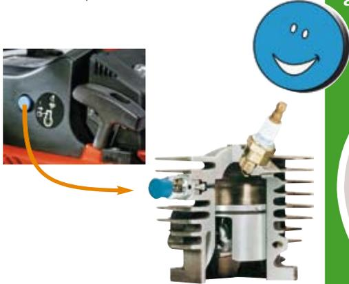
Cuando se genera la primera combustión, se cierra la válvula automáticamente y el botón HappyStart vuelve a su posición original, la máxima compresión es restaurada y el motor funciona. Normalmente, la reducción del esfuerzo entonces es de un 70% menor para el arranque del motor.
