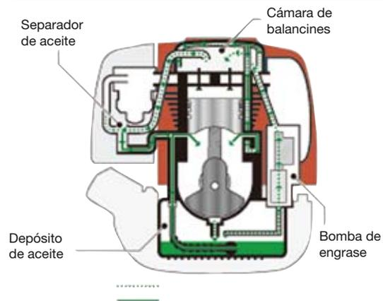
Nuestro sistema de lubricación, único y patentado, permite utilizar los nuevos motores 4T de 25,4 c.c. en cualquier posición, gracias a su nuevo sistema de retorno de aceite al cárter.
